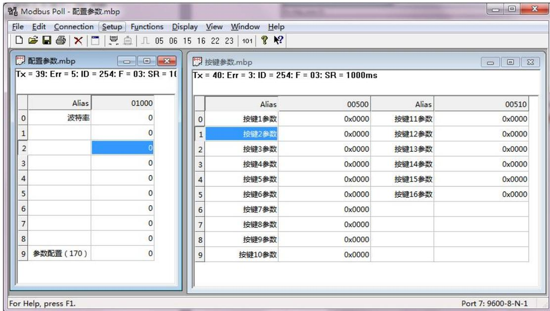
若提示 **Tx = 55: Err = 13: ID = 254: F = 03: SR = 1** **Timeout Error** 或 **Tx = 55: Err = 10: ID** **Timeout Error**，则表示设备未正常通讯，需检查通讯线和转换器是否正常。
