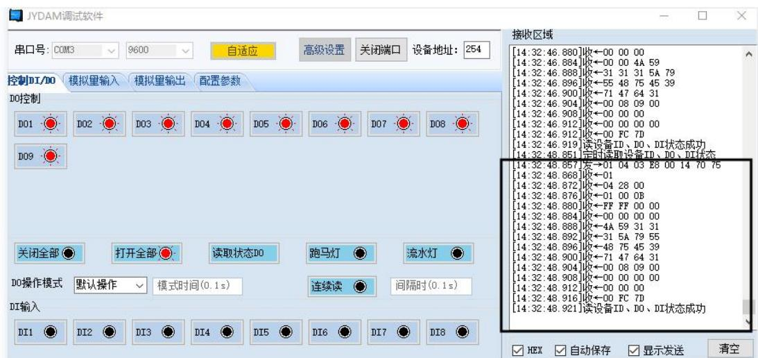
指令生成说明：对于下表中没有的指令，用户可以自己根据 modbus 协议生成，对于继电器线圈的读写，实际就是对 modbus 寄存器中的线圈寄存器的读写，上文中已经说明了继电器寄存器的地址，用户只需生成对寄存器操作的读写指令即可。例如读或者写继电器 1 的状态，实际上是对继电器 1 对应的线圈寄存器 0001 的读写操作。
